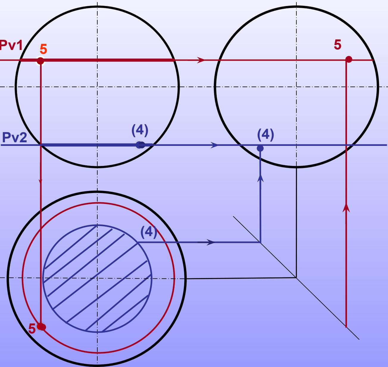
На главном «виде» через точку **5** проводят секущую плоскость  **$Pv1$**  параллельную горизонтальной оси симметрии. На виде «сверху» срез будет представлен в виде **окружности**, на которую переносят **точку 5**. На виде «сбоку» **точку 5** переносят уже известным способом.
