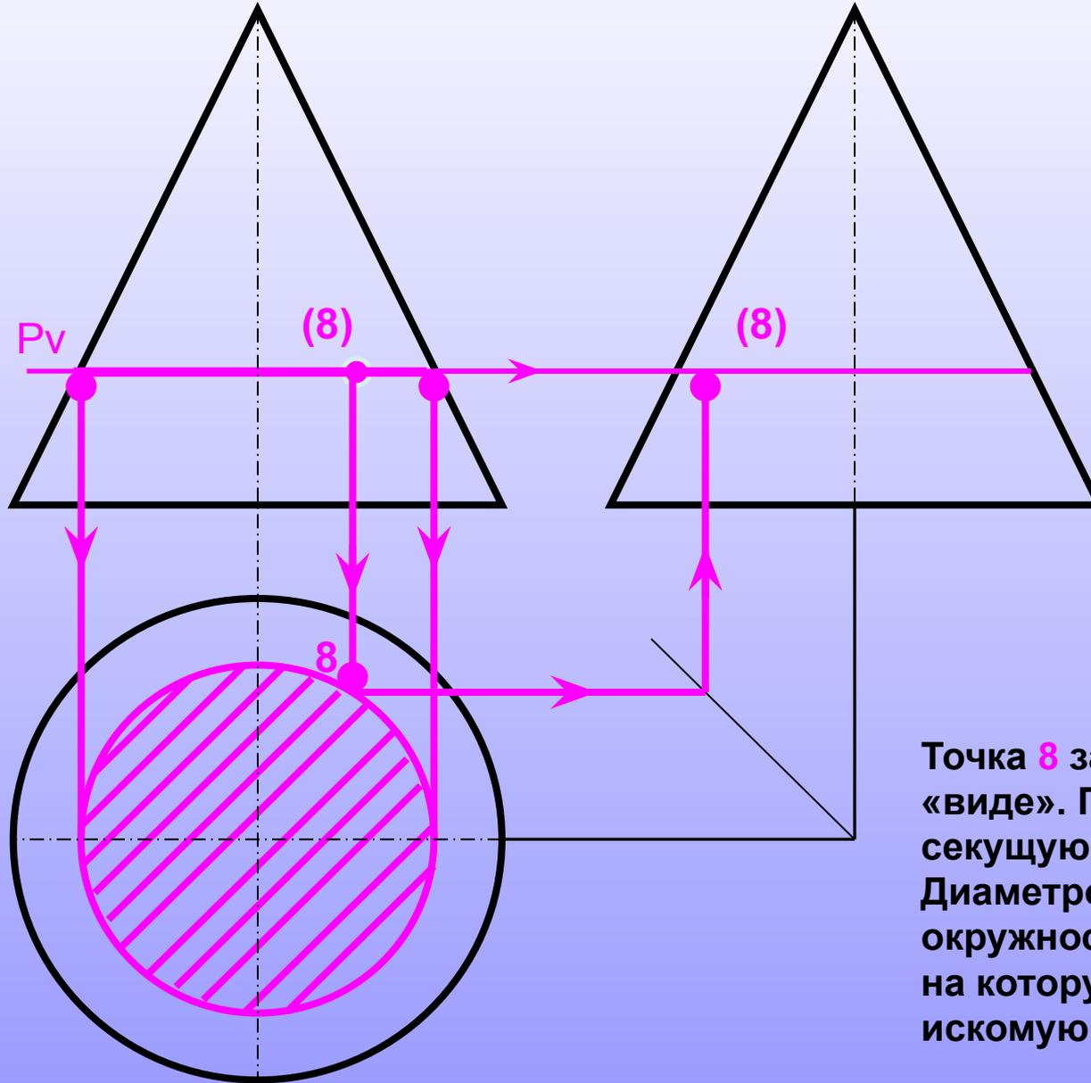
Точка **8** задана на главном «виде». Проводим через нее секущую плоскость **Pv**. Диаметр сечения строим окружность на виде «сверху», на которую переносим искомую **точку 8**.
