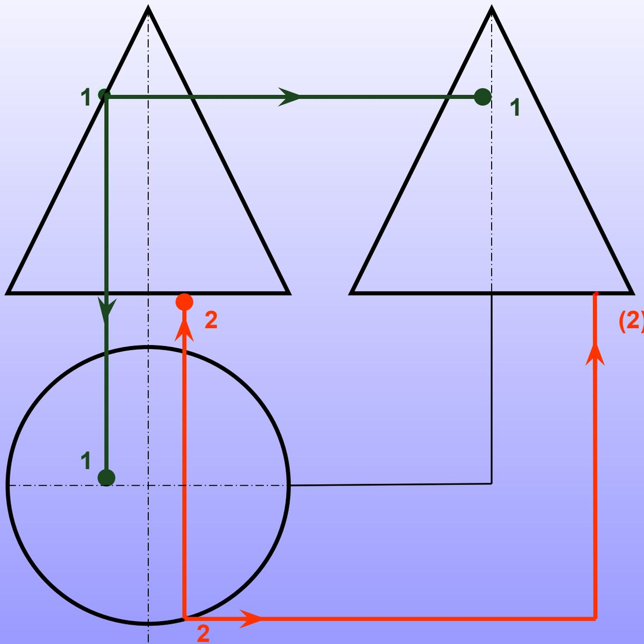
**Точка 1** расположена на «главном» виде на левой боковой образующей. Боковые образующие на виде «сверху» совпадают с горизонтальной осью симметрии, а на виде «сбоку» - с вертикальной осью, на которую и переносят **точку 1**.
