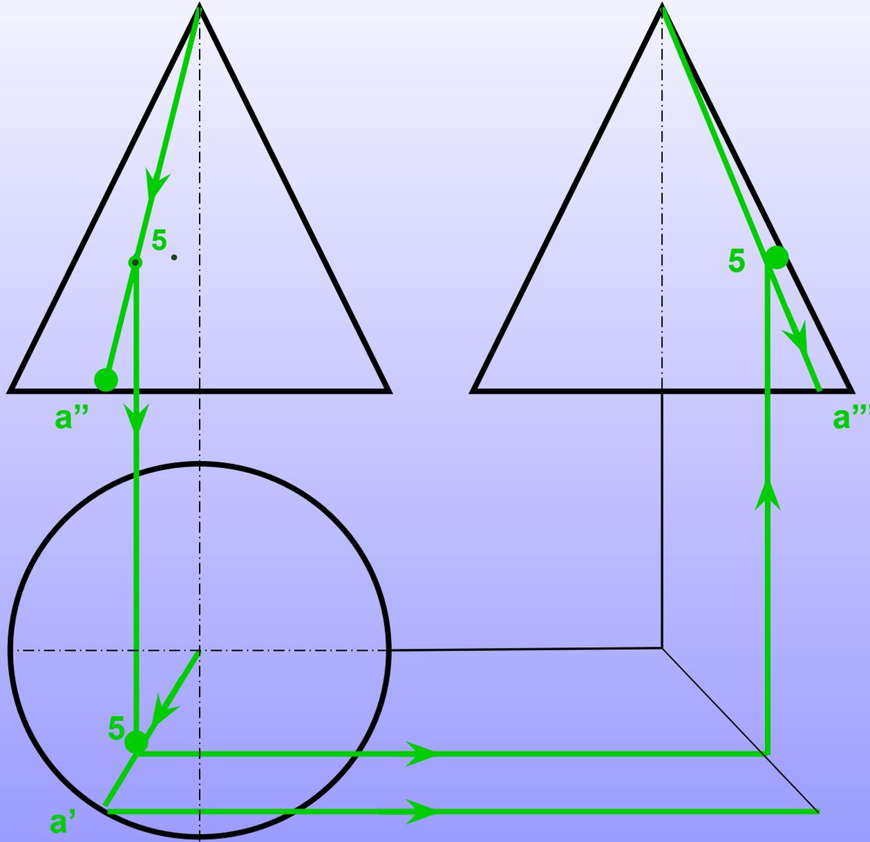
Проводим через нее образующие и на основании отмечаем **точку a''**, которую затем переносим на вид «сверху» (**точку a'**) и на вид «сбоку» (**точку a'''**). Соединив полученные точки **a'** и **a'''** с вершиной конуса, построим образующие на двух других проекциях. Затем спроецируем **точку 5** на эти образующие.
