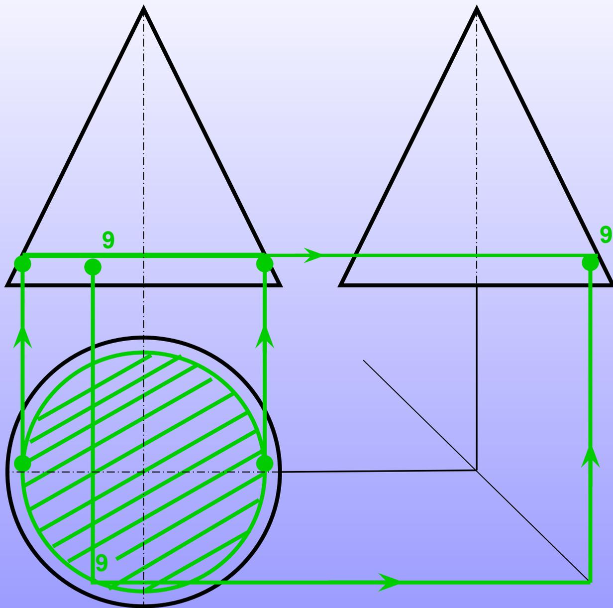
Проводя через нее секущую плоскость  $P_v$ , получим окружность, точки пересечения которой с горизонтальной осью переносят на боковые образующие «главного» вида. На вид «сбоку» точку 9 переносят известным способом.
