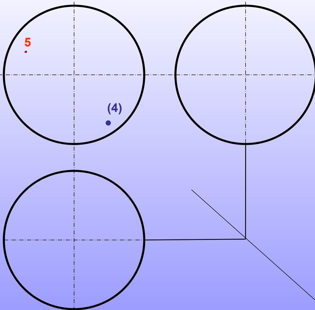
Для нахождения этих точек используем метод секущих плоскостей. Известно, что если шар срезать плоскостью параллельно вертикальной или горизонтальной оси симметрии, то на срезе получится окружность. Это правило используем для нахождения точек 4, 5 на двух других видах
