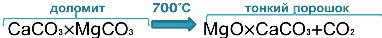
CaCO<sub>3</sub> - является пустой (инертной) породой, которая снижает вяжущие свойства каустического доломита.
