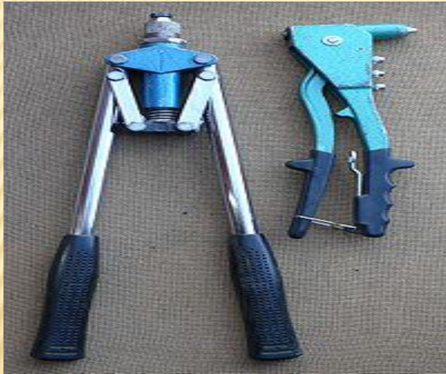
Фото 5.1 Бытовое устройство для установки отрывных заклёпок — «заклёпочник»
