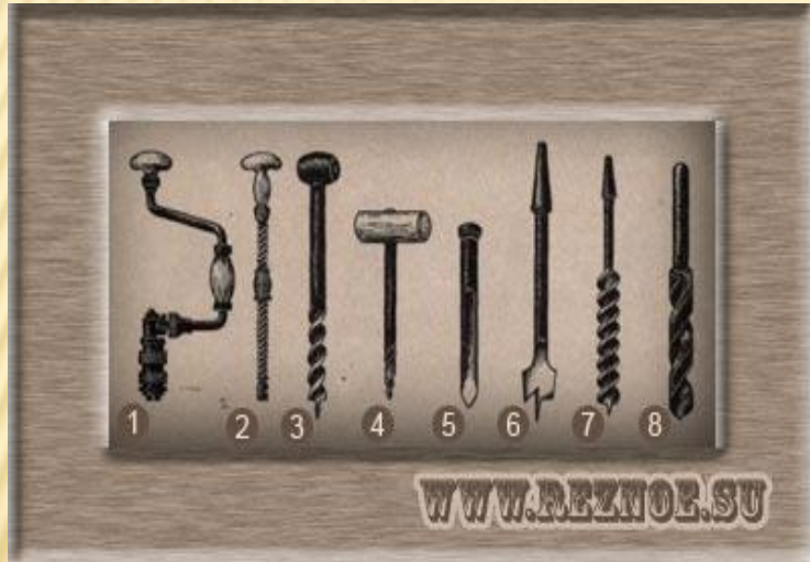
Рисунок 3.1 Инструменты для сверления : 1 — коловорот; 2 — сверлилка; 3 — бурав; 4 — буравчик; 5 — ложечное сверло; 6 — центровое сверло; 7 — винтовое сверло; 8 — спиральное сверло.
