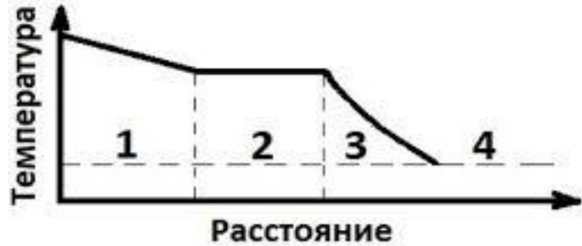
Схема распределения температуры в пласте при нагнетании в него водяного пара
