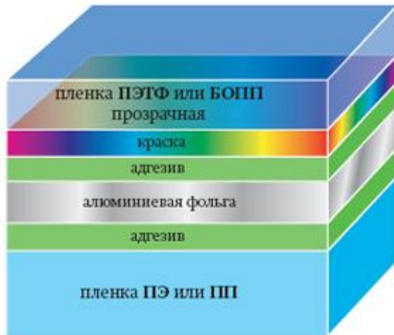
Пример многослойной пленочной структуры
