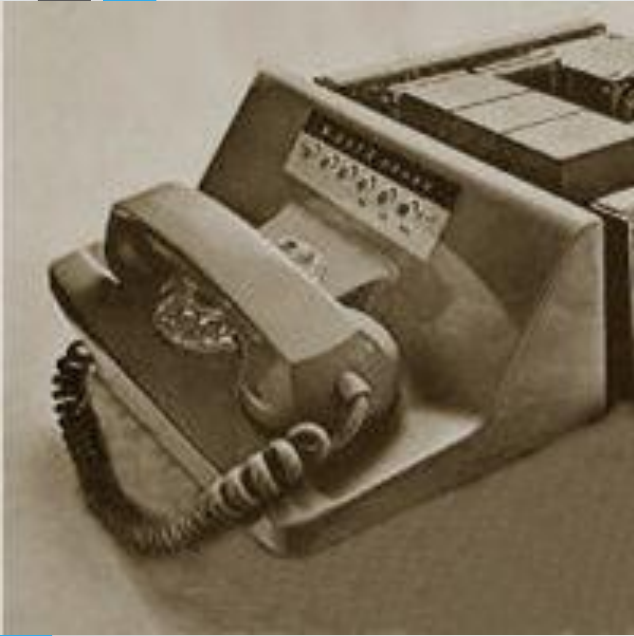
Первый коммерческий модем фирмы AT&T модель Bell Dataphone 103
