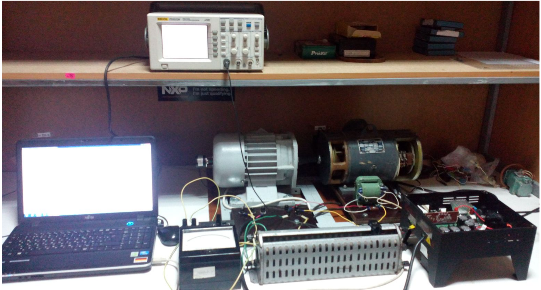
Рисунок 7 – Внешний вид стенда частотного управления АД
