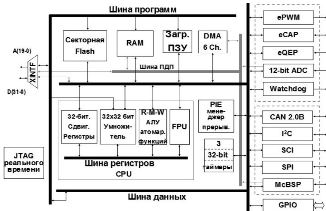
Рисунок 5 – Блок-схема контроллера TMS320F2833x
