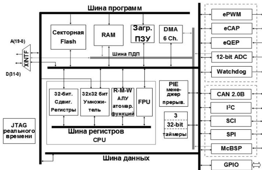
Рисунок 5 – Блок-схема контроллера TMS320F2833x
