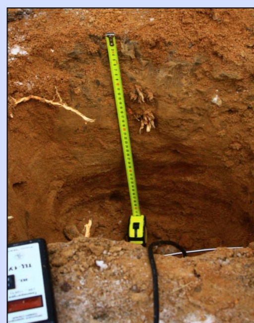
Рис. 3. Шурф в точке №1.5. Измерение t°C на границе мерзлого и талого грунта, измерение глубины сезонного промерзания. (Фото Турчинской О., 2013 г.)
