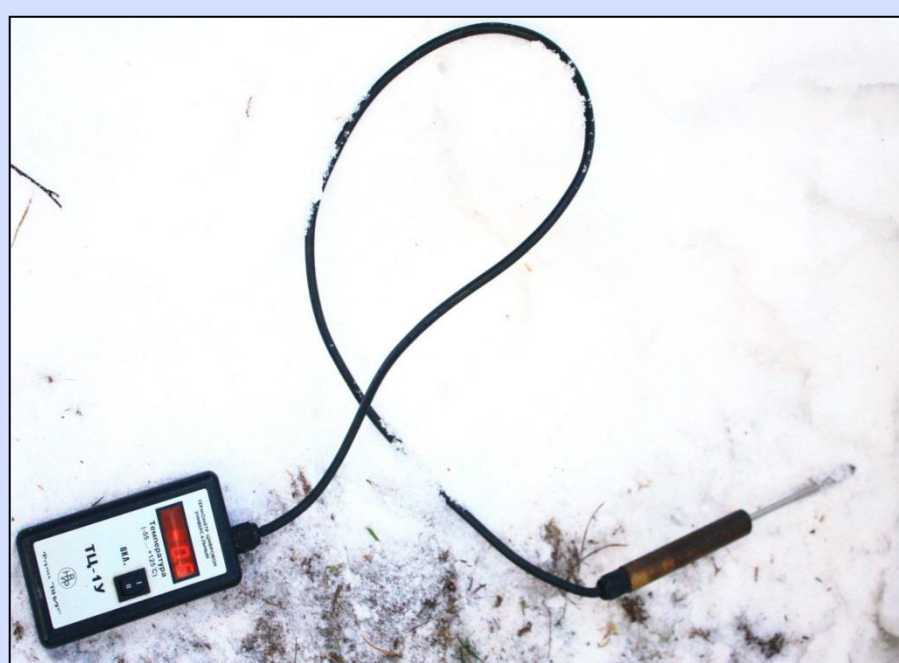
Рис. 4. Термометр ТЦ-1У. Измерение температуры на контакте с грунтом (Фото Турчинской О., 2013 г.)
