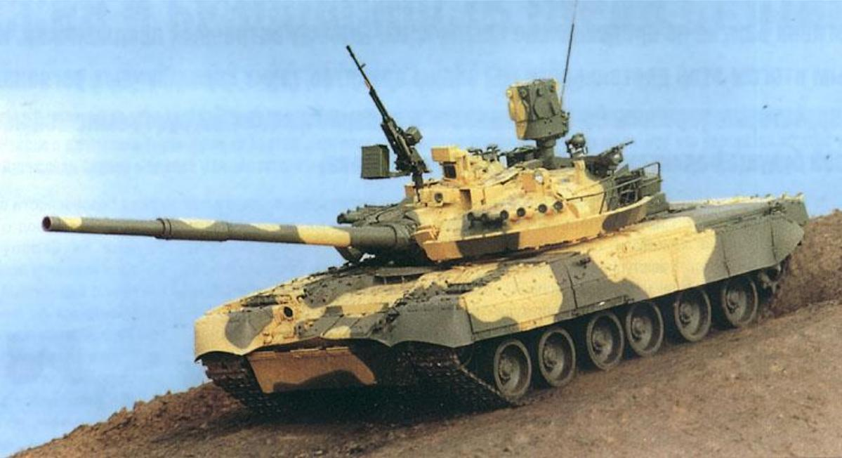
**Т-80** принят на вооружение в 1976 году. Впервые в мире он оснащен газотурбинным двигателем. На первых сериях Т-80 стоял ГТД-1000 мощностью 1000 л. с., на Т-80 модификаций Б(1978) и БВ(1985) - ГТД-1000ТФ мощностью 1100 л.с., а на Т-80У(1985) - ГТД-1250.
