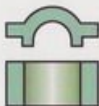
а - неразъемная деревянная модель
