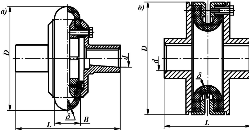
Рис. 16.11. Муфта с неразрезной торообразной оболочкой:
