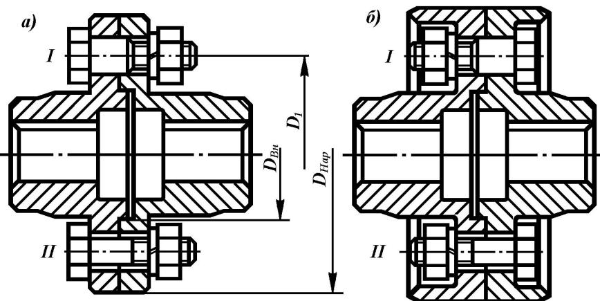
**Рис. 16.3. Муфта фланцевая:**
