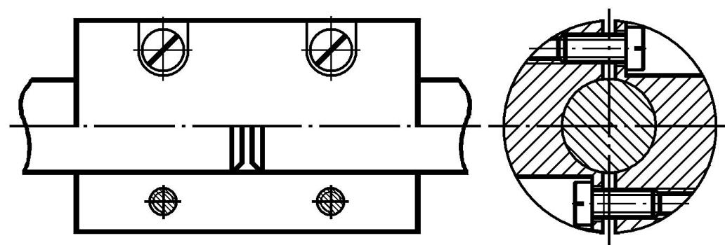
**Рис. 16.2. Муфта продольно-разъёмная**
