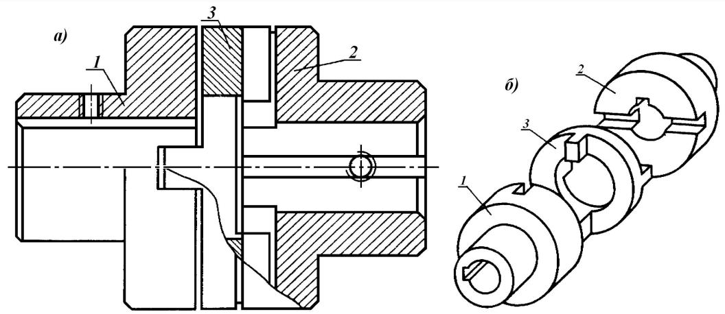
**Рис. 16.6. Муфта крестово-кулисная (кулачково-дисковая): а) в сборе; б) подетальная аксонометрия**
