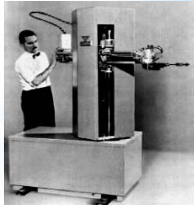
Рисунок 4 – Первый робот "Версатран", предназначенный для практического промышленного использования
