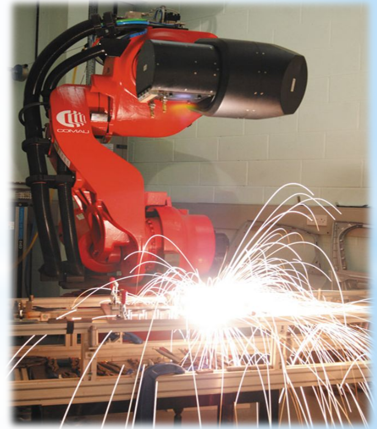
Рисунок 6 – Процесс сварки с помощью ПР
