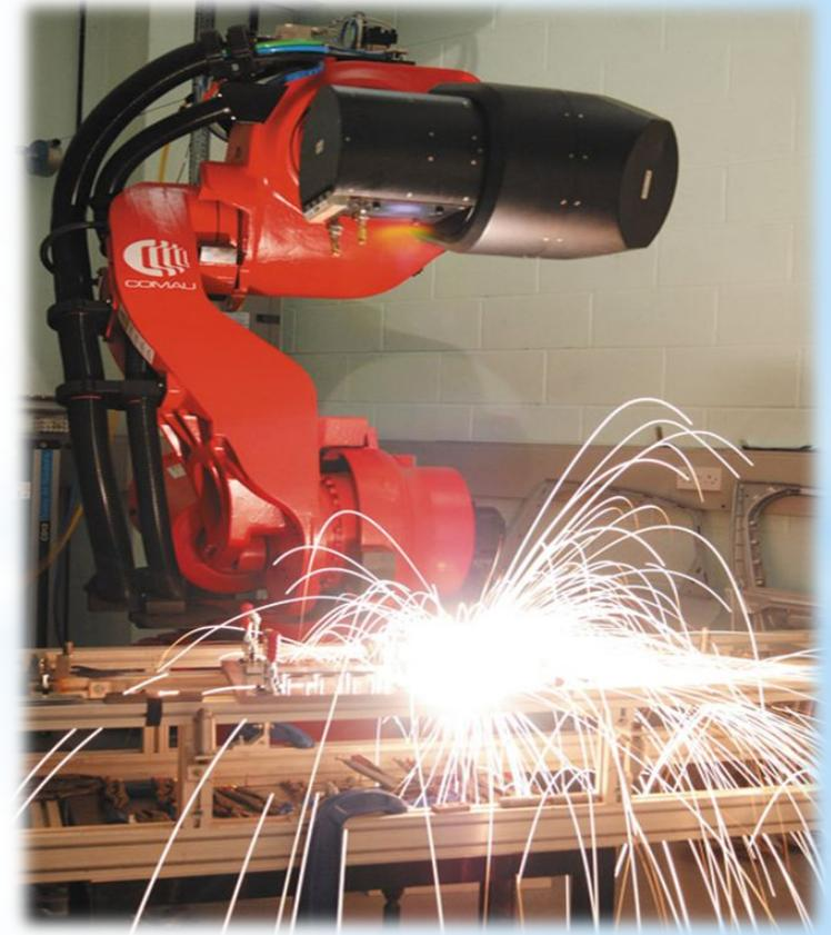
Рисунок 6 – Процесс сварки с помощью ПР
