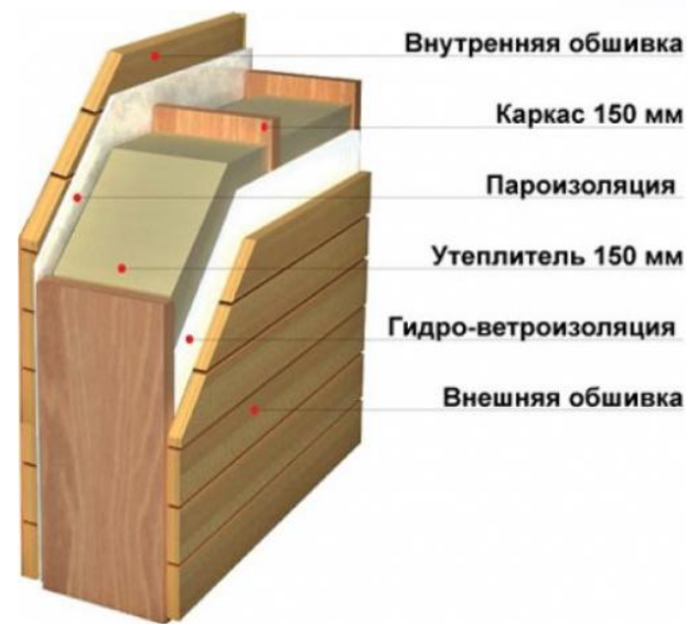
Внешний вид сборного щита
