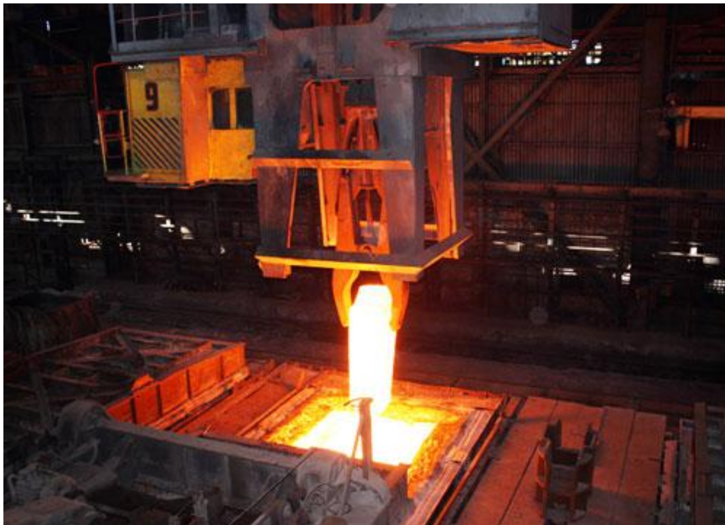
Установка слитков в колодец
