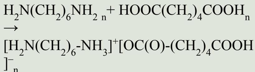
Для обеспечения строгой эквивалентности адипиновой кислоты и диаминa сначала готовят их соль (соль АГ) путем смешения реагирующих веществ в растворе метанола. Затем водный раствор или суспензию (60-80%) очищенной соли нагревают в автоклаве.
