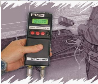
Дымомер портативный для дизельных ДВС МЕТА-01МП 0.1
