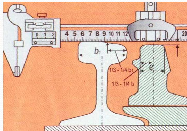
Измеряют величину понижения острия против рамного рельса с помощью рейки, накладываемой на два рамных рельса, и клина или специальным штангенциркулем "Путеец" в точке, расположенной на расстоянии  $1/3-1/4$  ширины головки рамного рельса от боковой рабочей грани.
