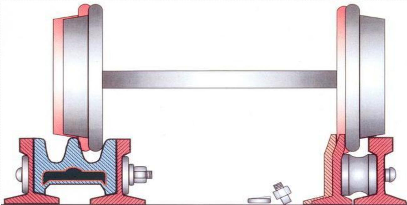
Разрыв хотя бы одного контррельсового болта и ослабленное болтовое крепление в корне остряков опасны тем, что нагрузка на оставшиеся болты увеличивается, и они могут не выдержать увеличенного давления от колес и оборваться, что может привести к сходу подвижного состава.
