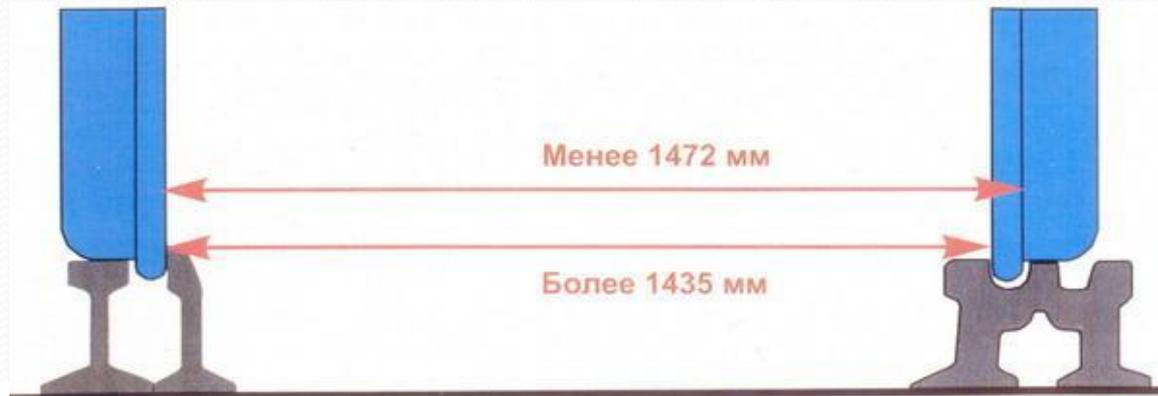
Крайне важным для обеспечения безопасности движения поездов являются требования, чтобы расстояние между рабочими гранями головки контррельса и усовика было не более 1435 мм, а расстояние между рабочей гранью сердечника крестовины и рабочей гранью головки контррельса - не менее 1472 мм.
