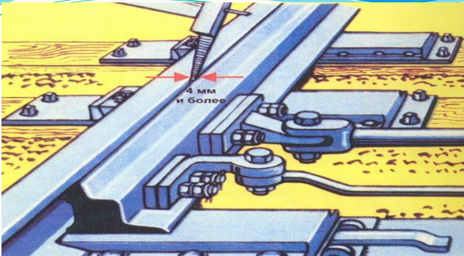
Неплотное прилегание острька к рамному, рельсу измеряют напротив первой соединительной тяги, при запертом положении стрелки специальным пластинкой — шаблоном.
