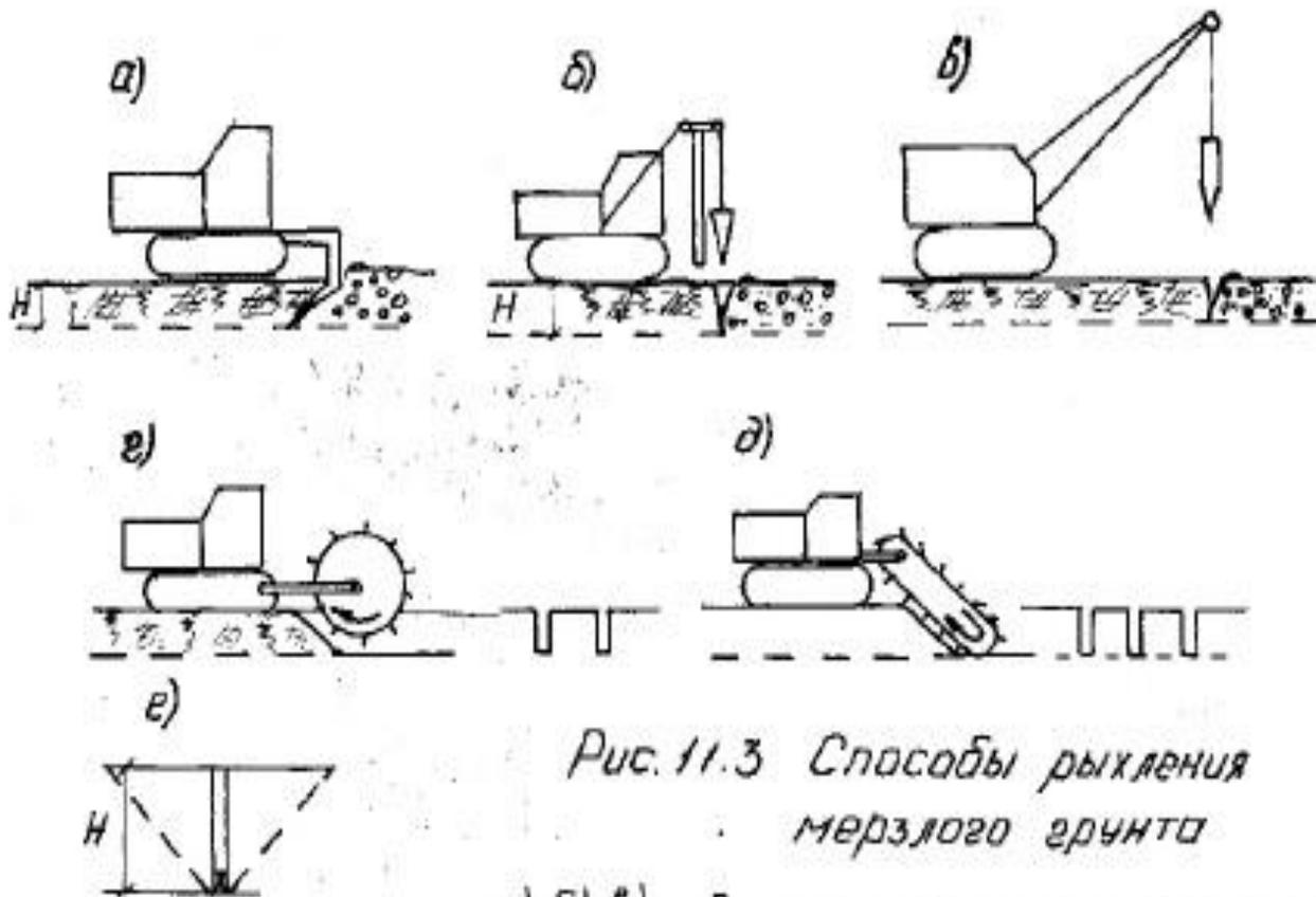
*Рис. 11.3 Способы рыхления мерзлого грунта*
