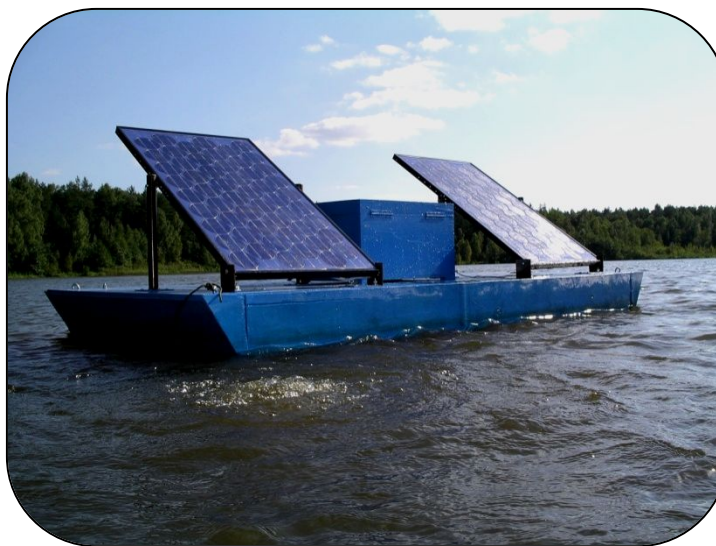
Плавучая аэрационная установка с питанием от солнечных фотоэлектрических батарей
