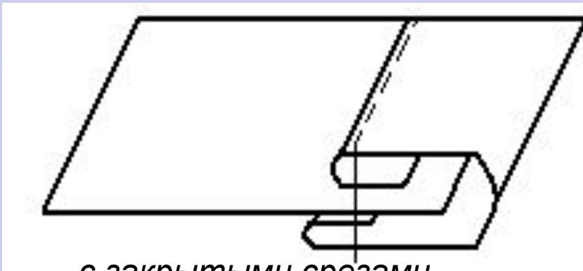
с закрытыми срезами, выполняемый на машине с приспособлением
