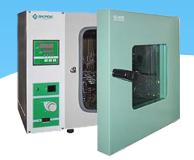
**Термовакуумный сушильный шкаф ES 4620** предназначен для сушки влажного шлама в потоке горячего воздуха с температурой нагрева 65-85°C в течении заданного периода времени (1-30 мин.).
