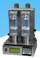
**Карбонатомер КУМ-1** предназначен для **р**аздельного определения содержания кальцита, доломита, сидерита и нерастворимого остатка в измельчённых образцах (керн, буровой шлам) горных пород.
