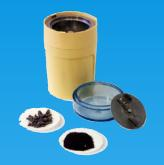
**Измельчитель шлама ЭМИШ-1** позволяет сделать измельчение пробы бурового шлама для приготовления тонкоизмельченных (до 0,10мм) навесок горных пород. Основан на механическом дроблении и истирании частиц горной породы специальными режущими ножами при высокой скорости вращения.
