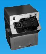
**Люминоскоп ЛРВ-1 с фотоустановкой** используется геологами станции ГТИ для визуальной диагностики и фотографирования капиллярных вытяжек, а также бурового шлама и керна с целью определения наличия и характера распределения в них битуминозных веществ при воздействии на образец ультрафиолетового излучения. Основан на свойстве нефти, асфальтенов и других битумоидов флюоресцировать при облучении их ультрафиолетовым излучением с длиной волны 365 нм, создаваемым специальным источником.
