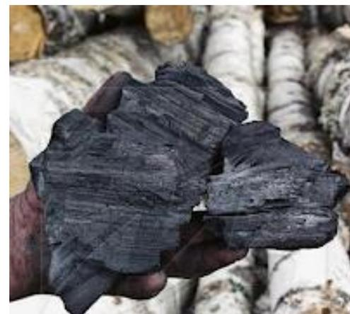
Древесный уголь — микропористый высокоуглеродистый продукт, образующийся при разложении древесины без доступа воздуха.
