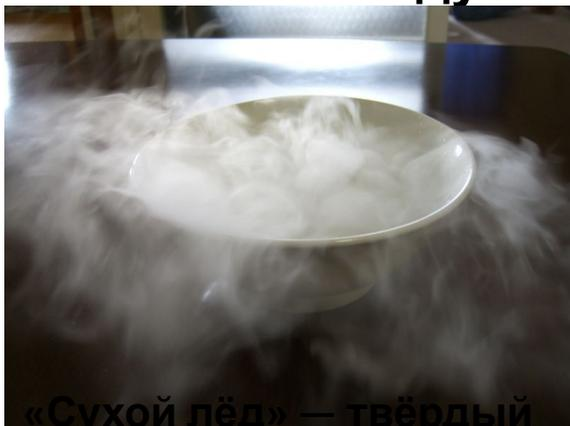
«Сухой лёд» — твёрдый  $\text{CO}_2$ , при обычных условиях (атмосферном давлении и комнатной температуре) переходящий в парообразное состояние, минуя жидкую фазу.
