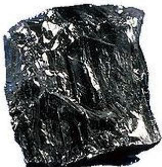
Каменный уголь – вид ископаемого топлива, образовавшийся под землёй при глубоком разложении растительных остатков без доступа кислорода. Содержание углерода в каменном угле в зависимости от месторождения составляет от 75% до 95%.
