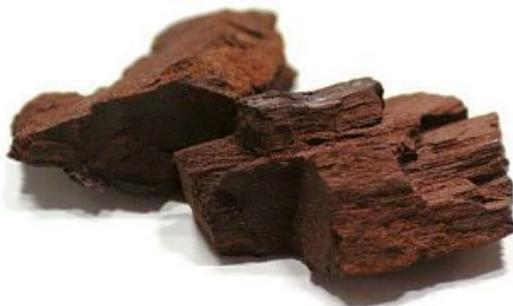
Бурые угли – твердые горючие ископаемые, образовавшиеся из торфа. Содержат 65-70% углерода, имеют бурый цвет.
