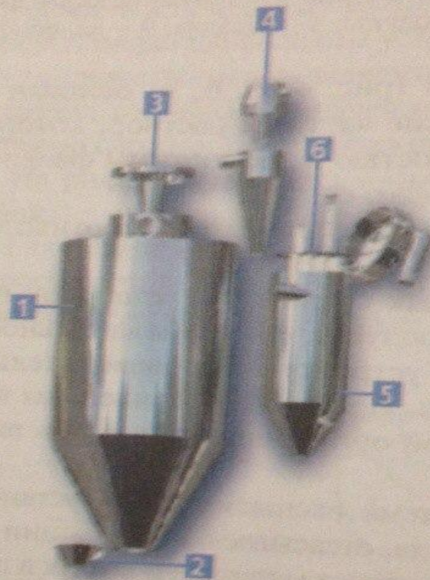
Рис. 4.67. Устройство распылительной сушилки фирмы GEA (Niro Pharma Systems):
