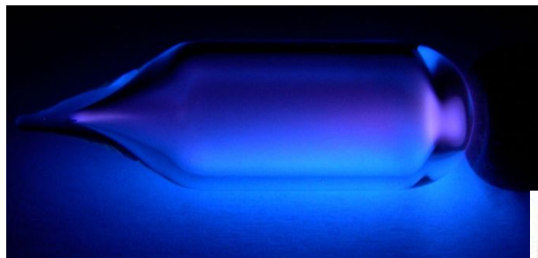
свечение азота в высокочастотном разряде
