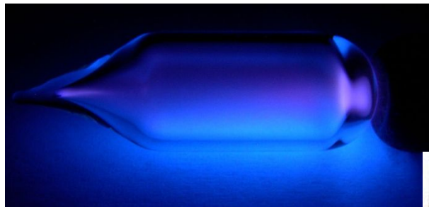
свечение азота в высокочастотном разряде
