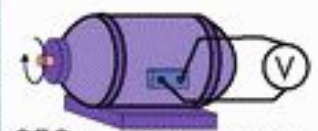
ЭДС электромашиного генератора E = C_e n \Phi
