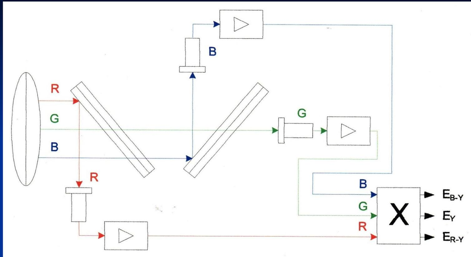
$E_Y$  – яркостный сигнал. Полученные сигналы обеспечивают формирование цветного полного телевизионного сигнала. Сигнал яркости  $E_Y$  является основным, который обеспечивает совмещение различных телевизионных систем. В телевизионном приёмнике получается сигнал зелёного цвета  $E_G$ , который не передаётся, а формируется по следующей формуле:
