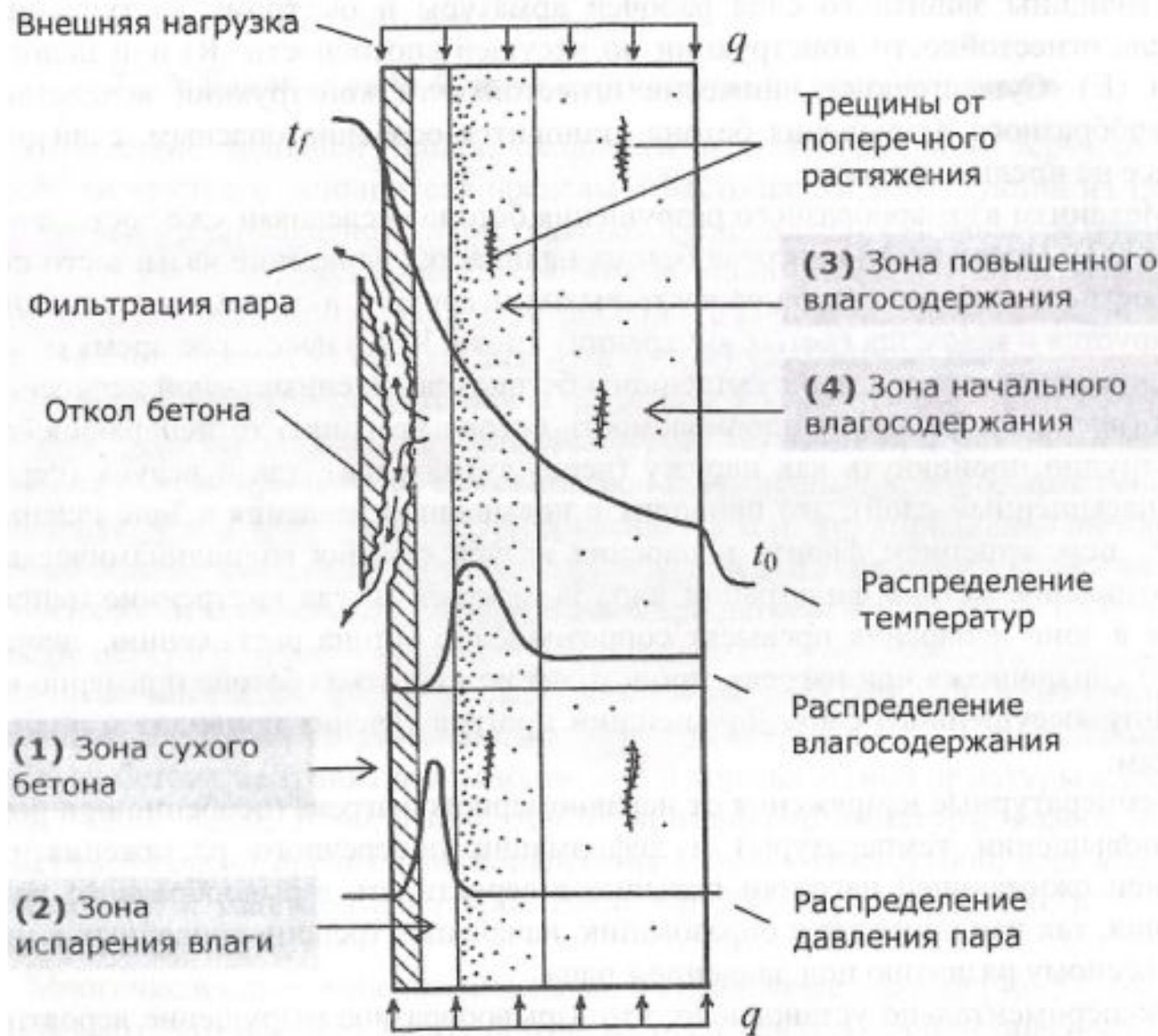
Схема 1 – Механизм «взрывообразного» разрушения
