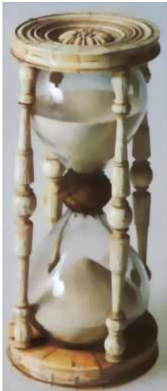
Два сосуда, соединенных узкой горловиной, через которую песок из верхнего сосуда перемещается в нижний. Песочные часы предназначены для измерения ограниченного отрезка времени – от нескольких секунд до нескольких часов или суток (в зависимости от размера часов).
