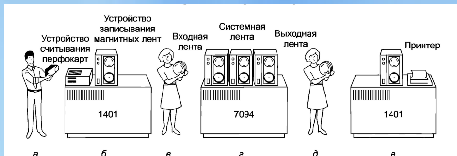
Рис. 1.3. Ранняя система пакетной обработки: программист приносит карты для IBM 1401 (а); IBM 1401 записывает пакет заданий на магнитную ленту (б); оператор переносит входные данные на ленте к IBM 7094 (в); IBM 7094 выполняет вычисления (г); оператор переносит ленту с выходными данными на IBM 1401 (д); IBM 1401 печатает выходные данные (е)
