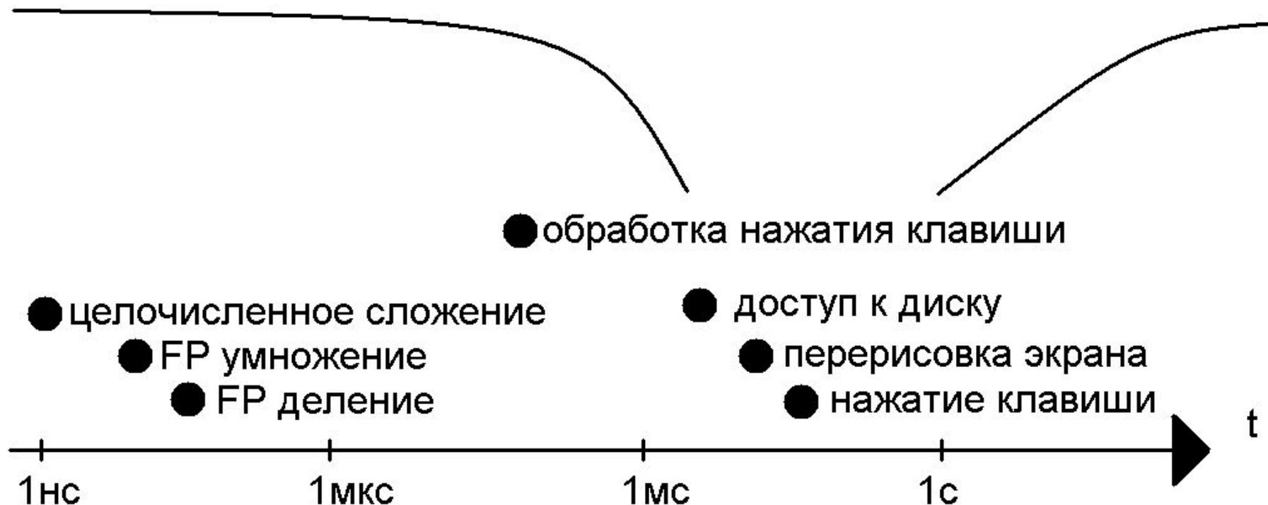
(для системы с тактовой частотой 1 ГГц)
