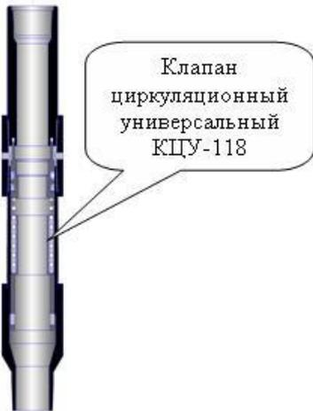
Предназначены для повышения эффективности и качества ОПЗ при ремонте добывающих и нагнетательных скважин нефтяных месторождений, а также для освоения скважин струйным насосом.
