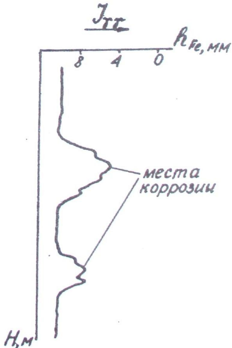
Рис. 3. Пример записи результатов гамма-гамма-толщиномера
