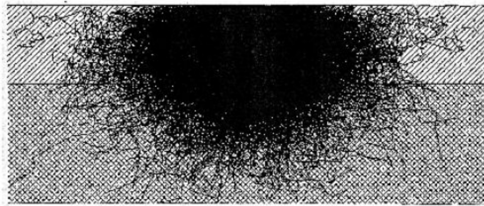
Рис. 13. Пример результата моделирования рассеяния оптического излучения в двухслойной среде с различными параметрами рассеяния в слоях методом Монте-Карло [62]
