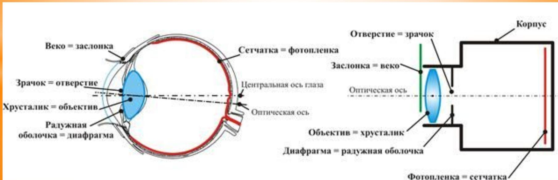
На рисунке справа, схематически показано устройство фотоаппарата. При фотографировании заслонка открывается (регулирует время освещения), световой поток, формирующий изображение, проходит через отверстие, диаметр которой регулируется диафрагмой (регулирует количество света), затем он проходит через объектив преломляется в нем и фокусируется на фотоматериале, который регистрирует изображение.
