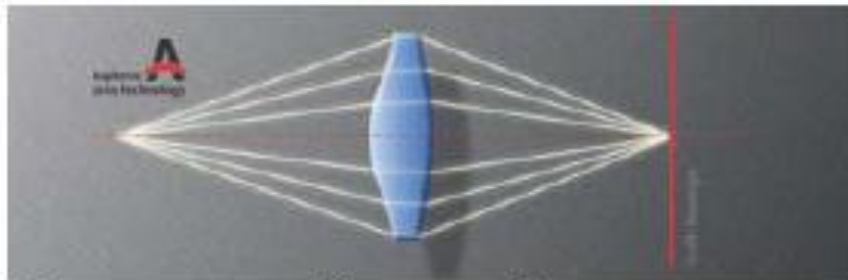
Прохождение лучей сквозь асферическую линзу. Даже боковые лучи фокусируются в одной точке
