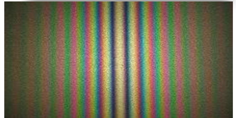
Интерференционная картина, полученная при помощи интерферометра с зеркалами под углом около 90^\circ
