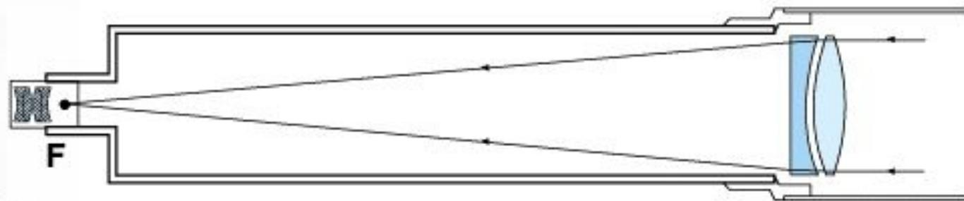
Преломляющие телескопы, или рефракторы, в качестве главного светособирающего элемента используют большую линзу-объектив. Рефракторы всех моделей и апертурах включают ахроматические (двухэлементные) объективные линзы - таким образом сокращается или практически устраняется ложный цвет (хроматическая aberrация), который влияет на получаемый образ, когда свет проходит через линзу.
