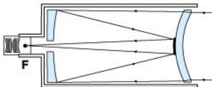
Зеркально-линзовые (катадиоптрические) телескопы используют как линзы, так и зеркала, за счет чего их оптическое устройство позволяет достичь великолепного качества изображения с высоким разрешением, при том, что вся конструкция состоит из очень коротких портативных оптических труб.
