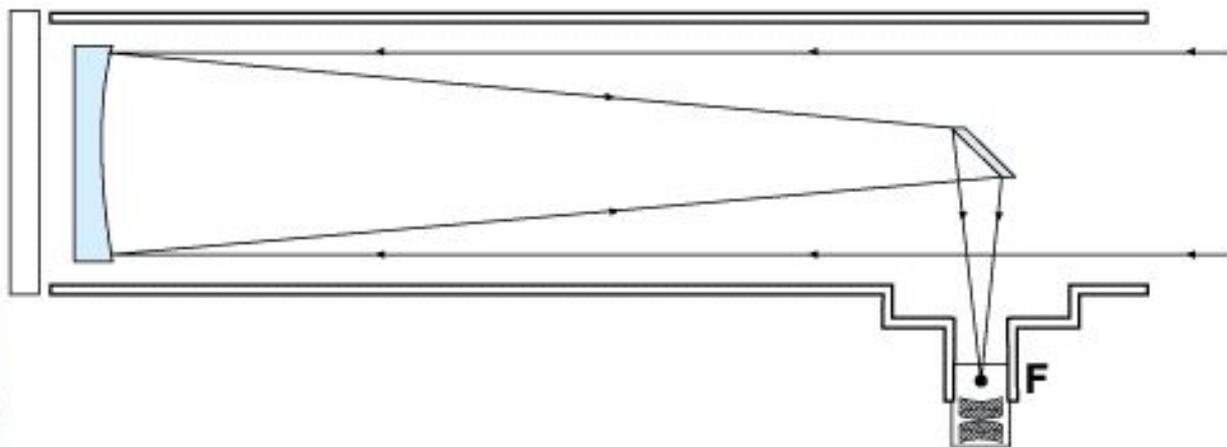
В отражающих телескопах, или рефлекторах, для сбора света и формирования изображения используется вогнутое главное зеркало. В рефлекторах ньютоновского типа маленькое плоское вторичное зеркало отражает свет на стенку главной трубы.
