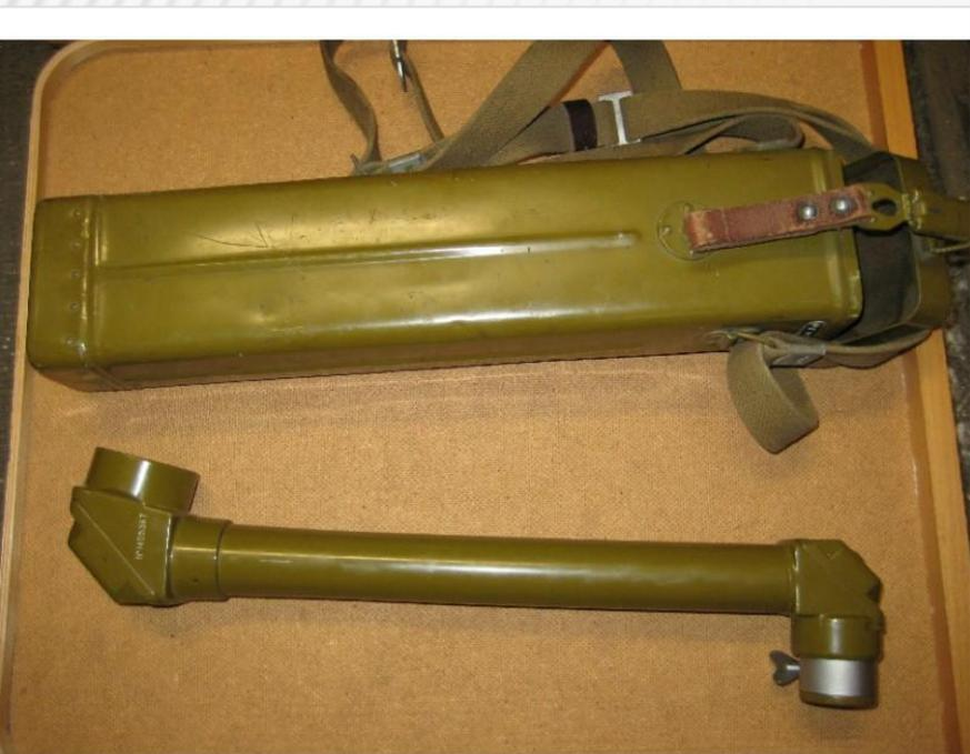
Перископ (от др.-греч. περί- — «вокруг» и σκοπέω — «смотрю») - прибор, позволяющий выносить точку обзора наблюдателя за пределы его тела, например, для наблюдения за объектами из укрытия.
