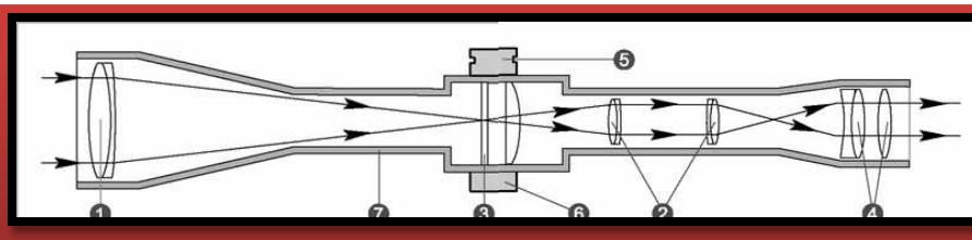
1. **Объектив** - система из двух (или более) линз. Диаметр объектива определяет светосилу прицела: чем больше диаметр тем больше он собирает света и обеспечивает лучшую "картинку" поля
