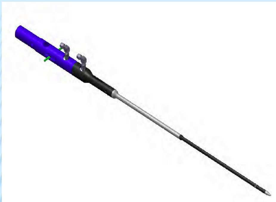
Общий вид инструмента для демонтажа и установки стопорных труб
