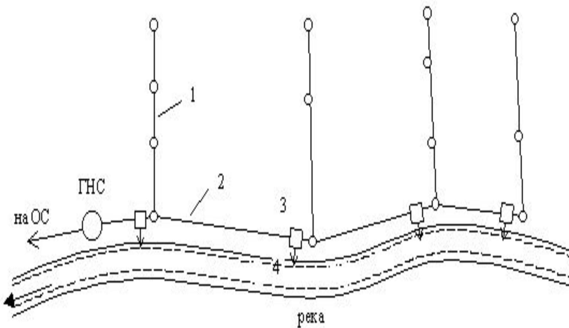
**Общесплавная система водоотведения: 1 - коллектор бассейна водоотведения; 2 - главный коллектор; 3 – ливенспуск; 4 – выпуск**
