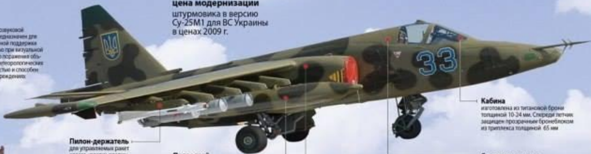
Спасение летчика обеспечивается катапультным креслом К-36П на скорости до 1000 км/час во всем диапазоне высот полета
