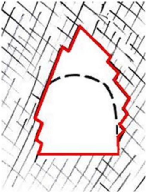
Разрушение по поверхностям ослабления: трещинам, контактам, напластованию.
