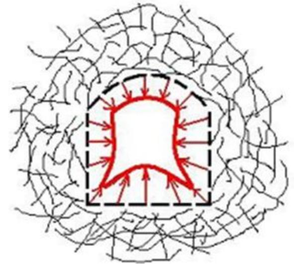
Смещение контура выработки. Из-за неравномерности смещений массив горных пород **деформируется**: сжимается, растягивается, изгибается, сдвигается.
