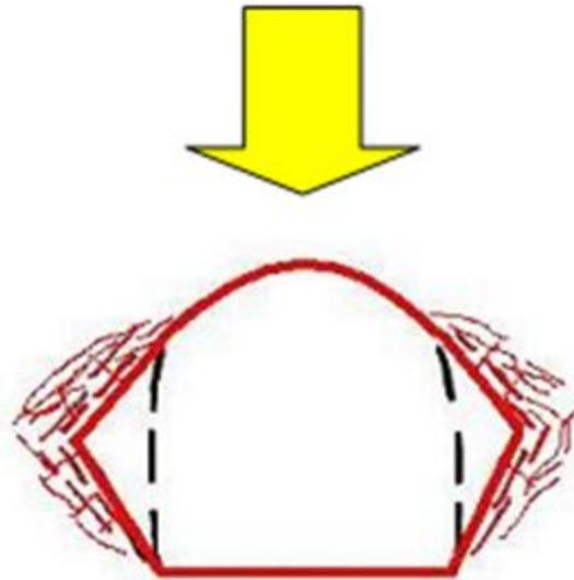
Разрушение в зонах концентрации напряжений: на большой глубине, в зоне влияния очистных работ
