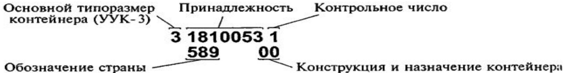
Рис. 3.8. Пример обозначения среднетоннажного контейнера
