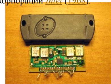
Гибридная микросборка STK403-090, извлечённая из корпуса
