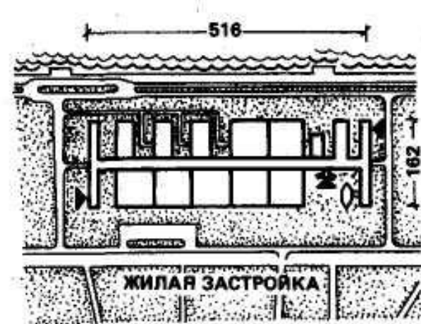
Пример секционно-гребенчатой застройки для предприятия легкой промышленности
