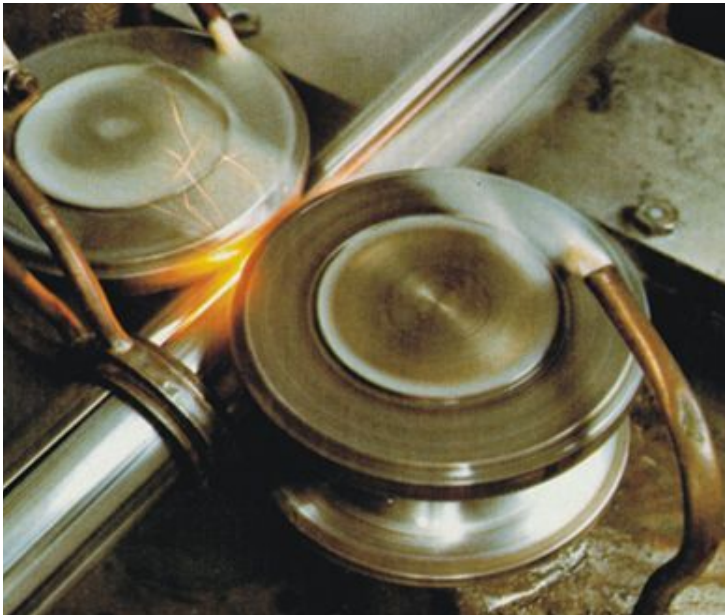
Простейший сварочный узел
