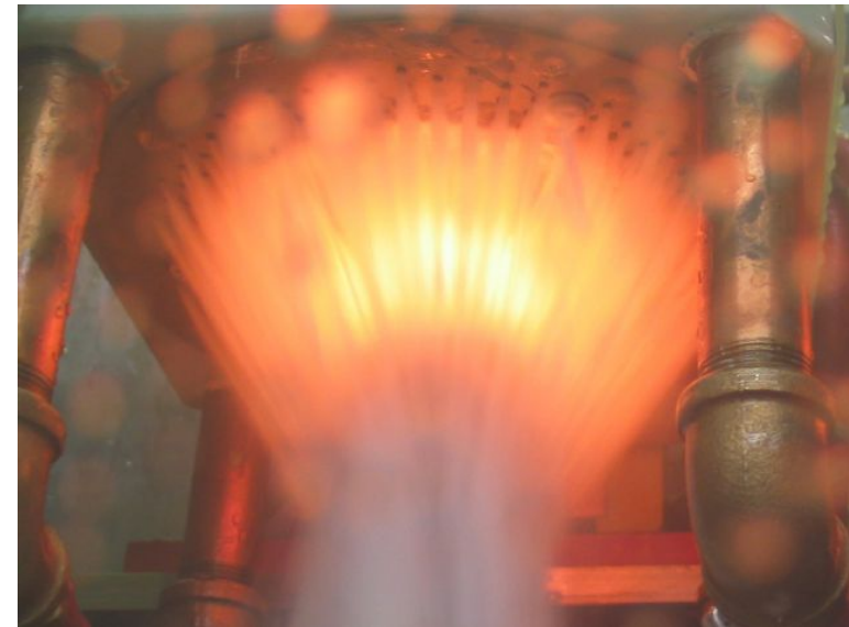
Последовательная закалка полуоси, AjaxTOCCO Magnethermic
