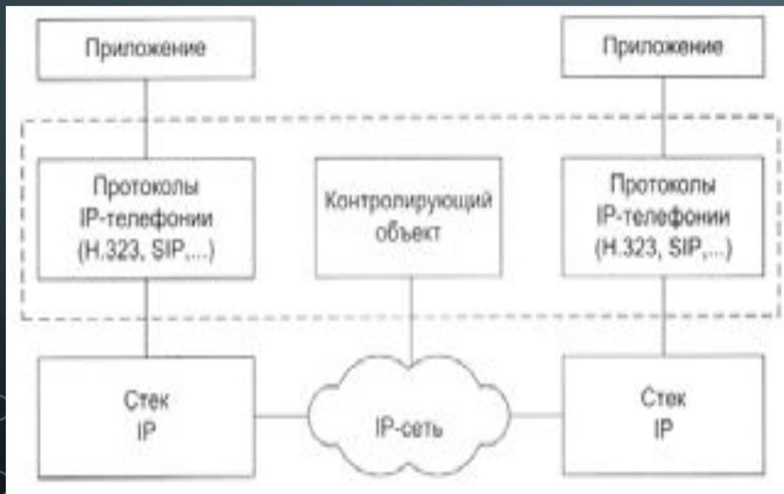
Для установления соединения между вызываемым и вызывающим абонентом шлюзы IP-телефонии должны:
