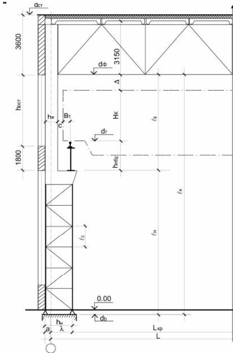
Рис. Компоновка поперечной рамы цеха
