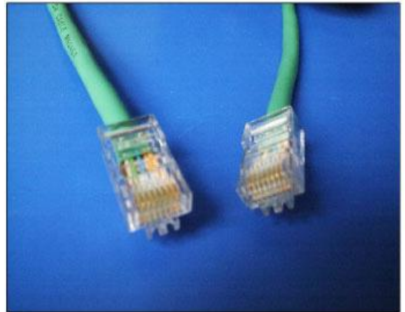
Неэкранированная витая пара – UTP (Unshielded Twisted Pair)
