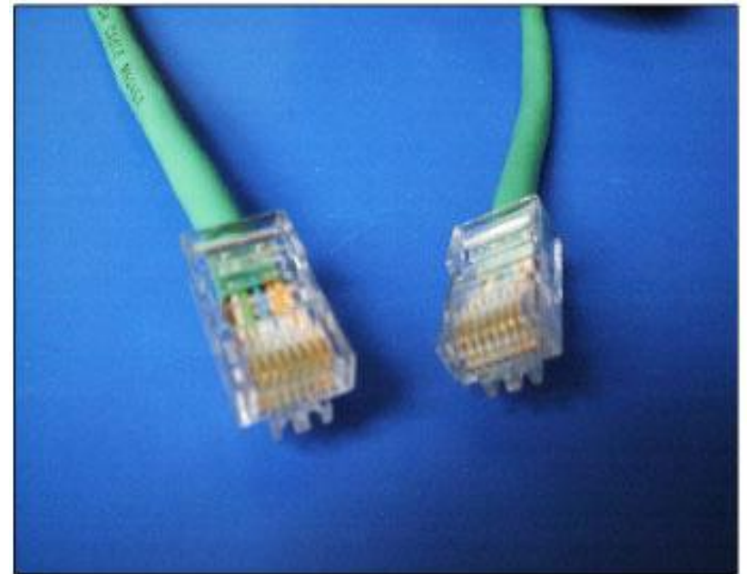
Неэкранированная витая пара – UTP (Unshielded Twisted Pair)
